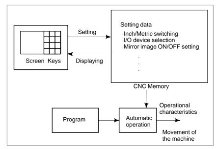
Fig. 1.6 (d) Displaying and Setting Operator's setting data
