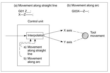
Fig. 1.1 (d) Interpolation function
