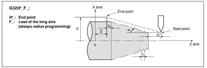
Fig. 4.8 (d) Example of Thread Cutting
