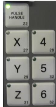
En esta sección se encuentran los ejes de movimiento de la máquina, el movimiento longitudinal de la máquina corresponde al eje **X**, el movimiento transversal corresponde al eje **Y**, el movimiento vertical corresponde al eje **Z**, las teclas 4 y 5 son opcionales.
