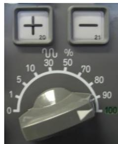
Las teclas de los signos positivo (+) y negativo (-) determinaran la dirección de movimiento de cualquiera de los ejes seleccionados **X**, **Y**, **Z**, según sea el movimiento deseado. El movimiento del eje permanecerá mientras el botón del signo más o menos este presionado y la maquina en modo **MANUAL**.
