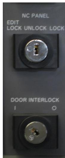
Selector de llave para activar y desactivar el candado de seguridad de la puerta de acceso a la máquina. A1 estar desactivado tendrá acceso a los movimientos manuales de la máquina con la puerta abierta. Manejando los movimientos a un 30% de lo normal.
