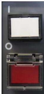
Este botón es un interruptor que activa el suministro eléctrico a los sistemas de control y servomotores. El interruptor principal de costado del gabinete de control deberá ser activado primero. Cuando se oprime el interruptor **CONTROL ON** este encenderá. Este interruptor servirá también para desactivar la alarma de paro de emergencia, una vez desactivado el paro de emergencia.
