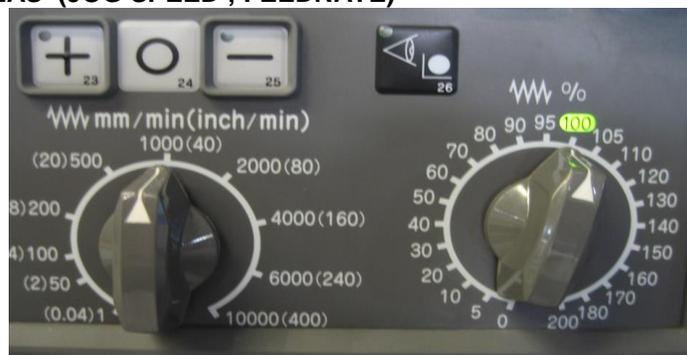
Estas teclas son utilizadas para seleccionar la dirección del movimiento en cualquiera de los ejes, seleccionado en el área de **AXIS SELECT** en la dirección que sea necesaria, estas Operaciones deberán realizarse en manual. Para detener el movimiento presione la tecla localizada entre las dos teclas de los signos.
