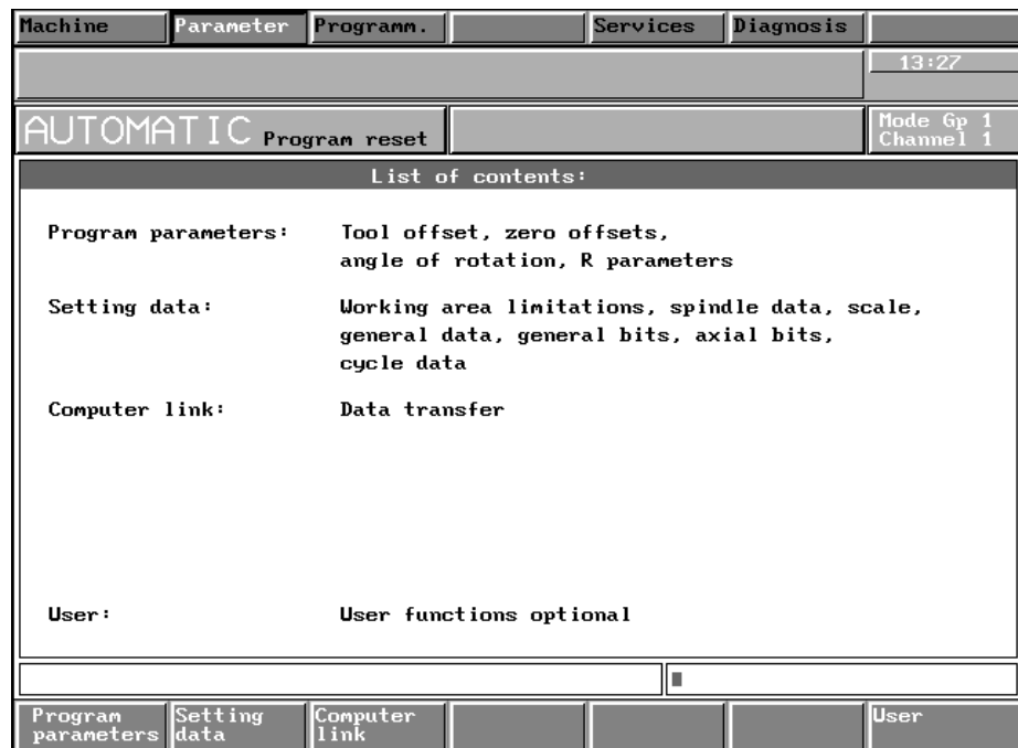
Fig. 4.2 Basic display, parameter area
